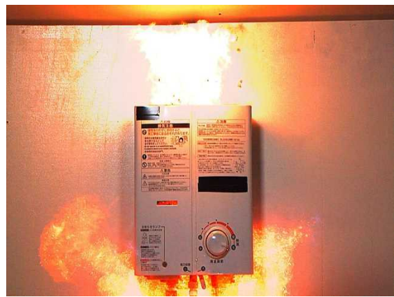
写真1. ガス瞬間湯沸器に未燃ガスが滞留して、異常着火
