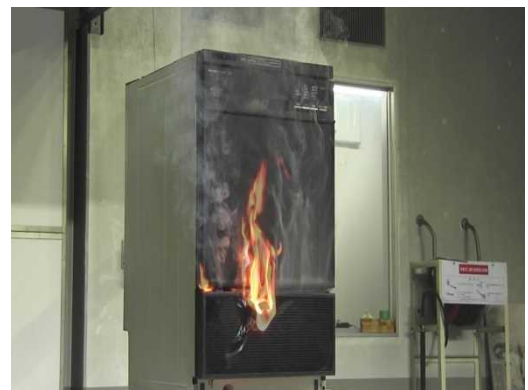
写真2. ビルトイン式電気食器洗機の長期使用による発火
